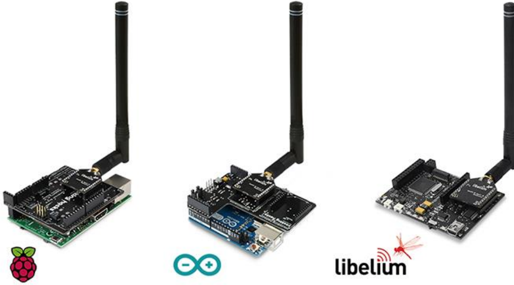
Şekil 4. Raspery Pi, Arduino ve Libelium ile LoRa Modülleri Kullanımı [ Waspnote Technical Guide, 2016]
