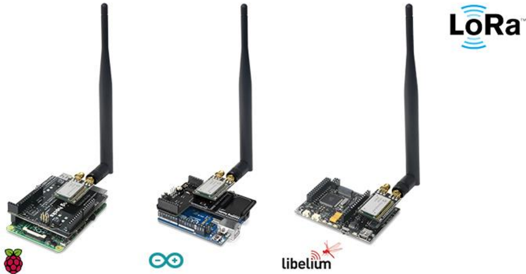
Şekil 7. - Raspery Pi, Arduino ve Libelium ile LoRaWAN Modülleri Kullanımı (Wasp mote Technical Guide, 2016)
