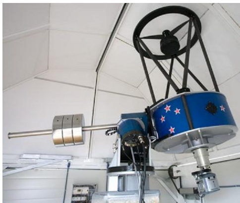
Şekil 9. 60 cm ayna çaplı karbon-fiber yapı teleskop
