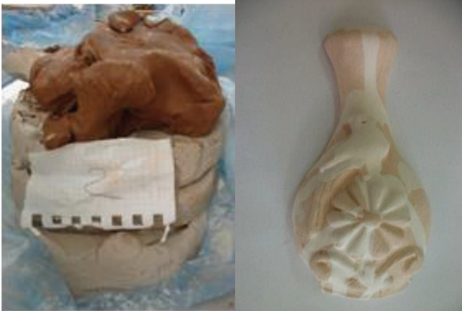
Resim-6 Deneme 2 için çamur karışımının yoğrulma aşaması ve 920°de pişme rengi
