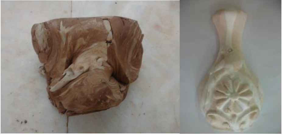
Resim-5 Deneme 1 için çamur karışımının yoğrulma aşaması ve 920°de pişme rengi
