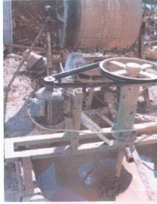
Resim 33. Çamurun hazırlanmasında kullanılan değirmen ve karıştırıcı.
