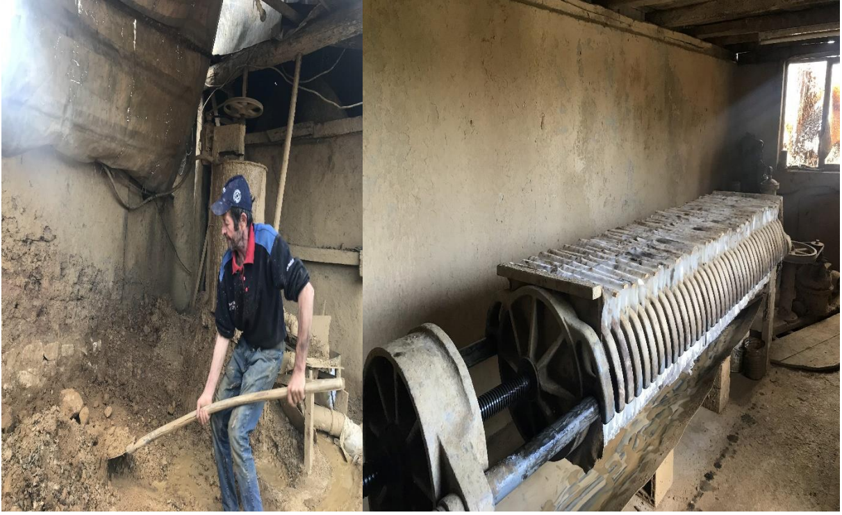
FOTOĞRAF 28- Hayrettin DESTİCİOĞLU kendi atölyesinde çamur hazırlarken (solda), filter press (sağda). 2022 Necmi TEKİN arşivi.
