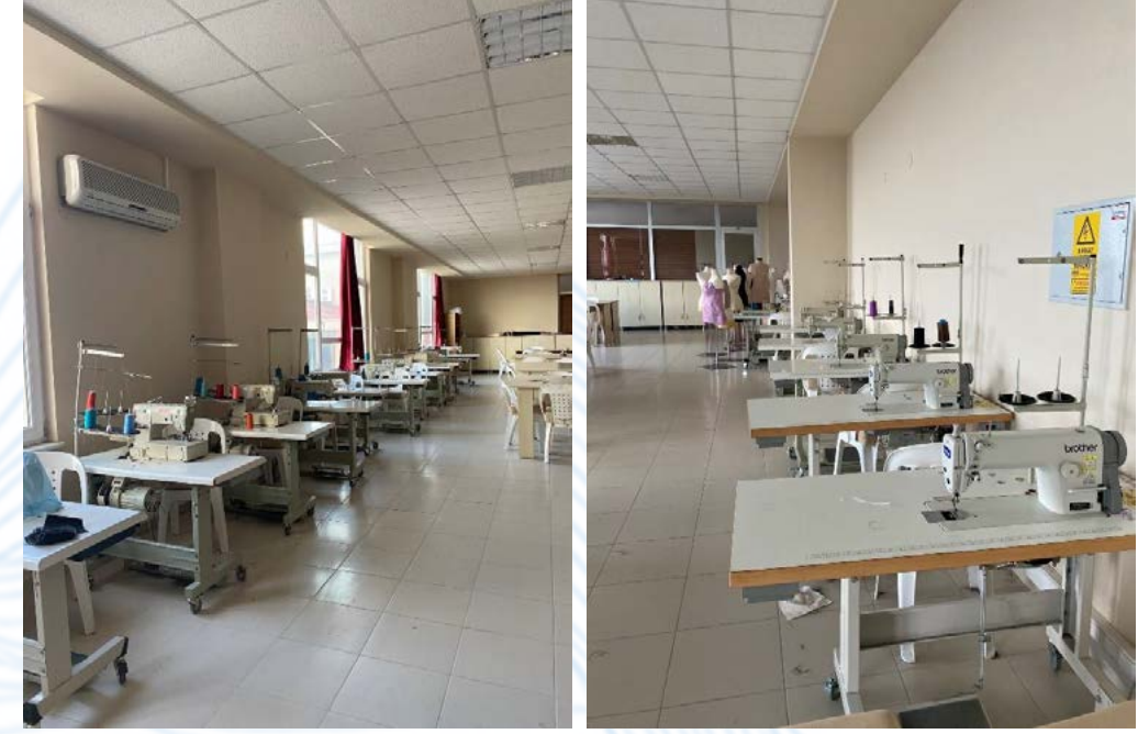
Resim 2. Atölyede Bulunan Farklı Özelliklerde Düz Dikiş ve Overlok Makineleri
