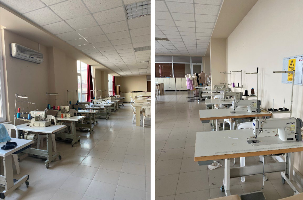
Resim 1. Atölyede Bulunan Farklı Özelliklerde Düz Dikiş ve Overlok Makineleri
