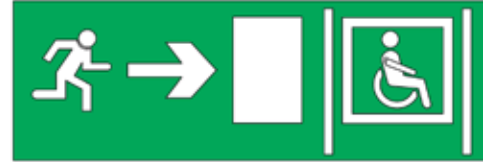
(p) Yangın tahliyesinde kullanılacak asansöre giden Erişilebilir güzergah
