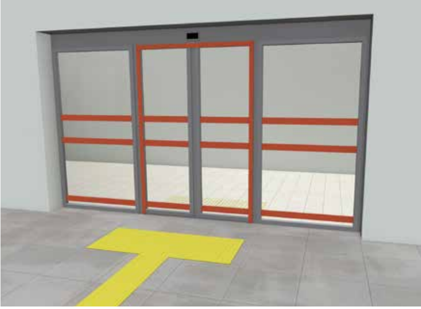
Şekil 4.5. Büyük Cam Yüzeyle Giriş Kapılarının İşaretlenmesi
