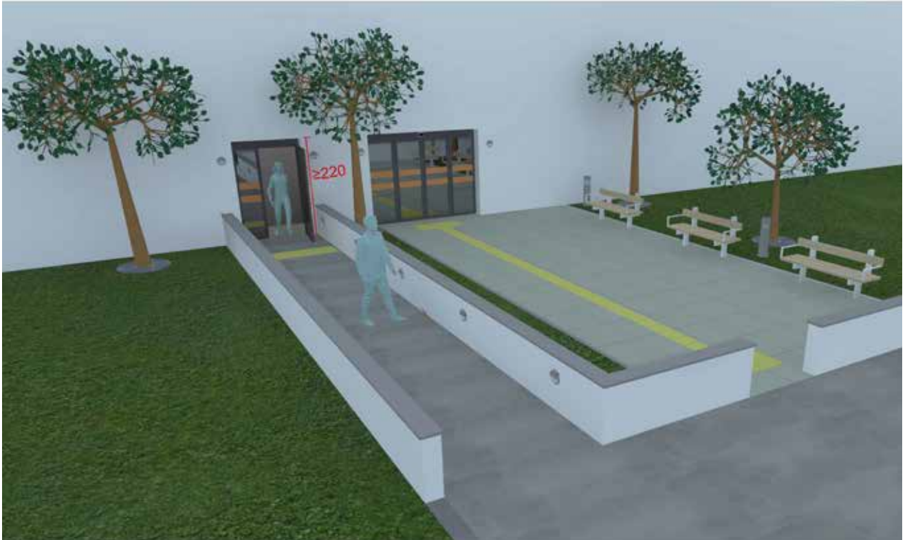
Şekil 2.5. Bahçe Yolunda Bordür Takibi ve HYYİ Uygulaması
