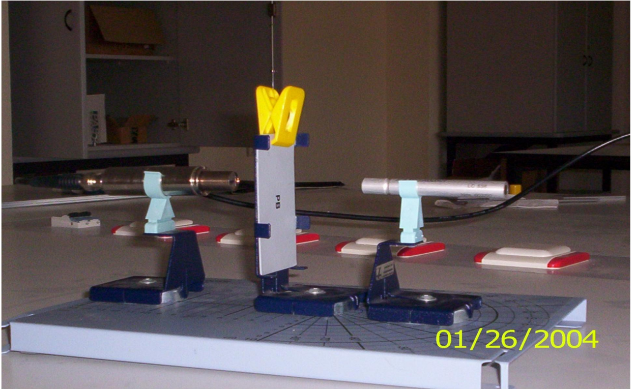
Resim 2: Soğurma katsayısı için deney düzeneği
