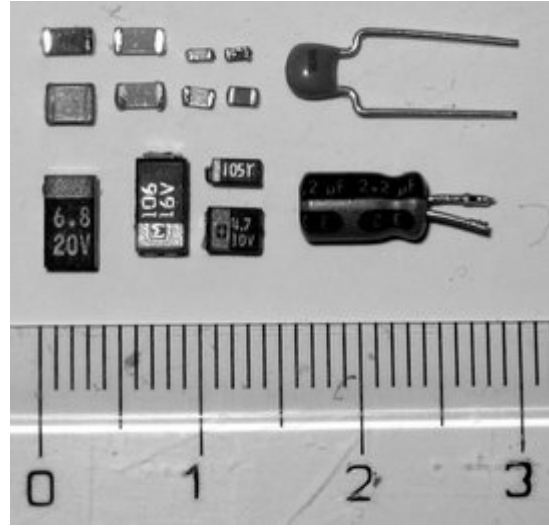
SMD kapasitörler : Alt kısımda elektrolitikler, onların üstünde de seramikler; "klasik" seramik ve elektrolitik kapasitörler karşılaştırma için sağ kısma konulmuştur
