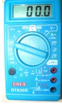
Şekil-2: Avometre (Amper, Volt, Ohm); akım, gerilim ve direnç ölçmede kullanılan cihazdır.
