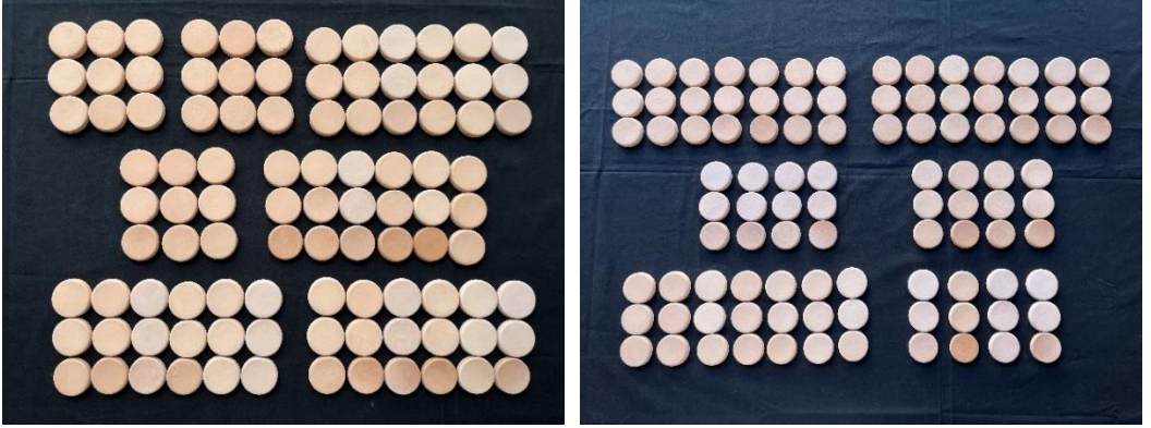
Görsel 4.14. Alçı kalıba basma yoluyla plastik şekillendirilen numunelerin çamur türlerine ve bileşim gruplarına göre 1000°C, 1050°C, 1100°C'de pişme sonuçları.
