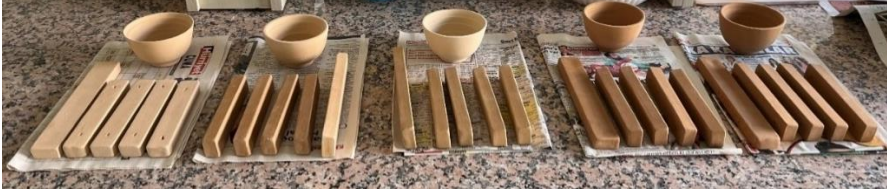
Görsel 4.7. Yoğrulma suyu ve kuru direnç tayini numune örnekleri.
