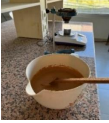
Görsel 4.5. Litre ağırlığı, tiksotropi tayini ve döküm yöntemi ile numune üretimi.
