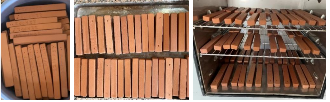
Görsel 4.9. Su emme tayini yapılan deney numuneleri.
