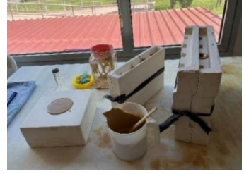
Görsel 4.5. Litre ağırlığı, tiksotropi tayini ve döküm yöntemi ile numune üretimi.
