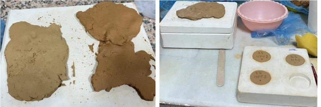
Görsel 4.13. Alçı kalıp yoluyla plastik şekillendirme.
