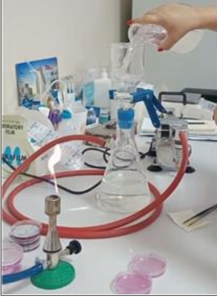
Şekil 2. Membran filtrasyon yöntemi (NKS pedleri)
