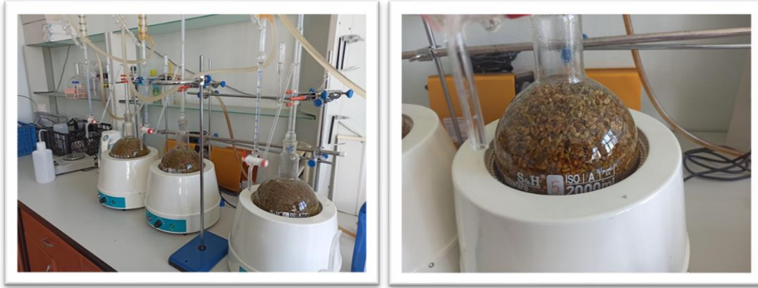
Şekil 3. İstanbul kekiğinin uçucu yağ elde edilmesi düzeneği
