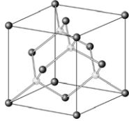
CdTe birim hücre yapısı (Siyah noktalar Cd atomları, beyaz noktalar Te atomlarını göstermektedir.)
