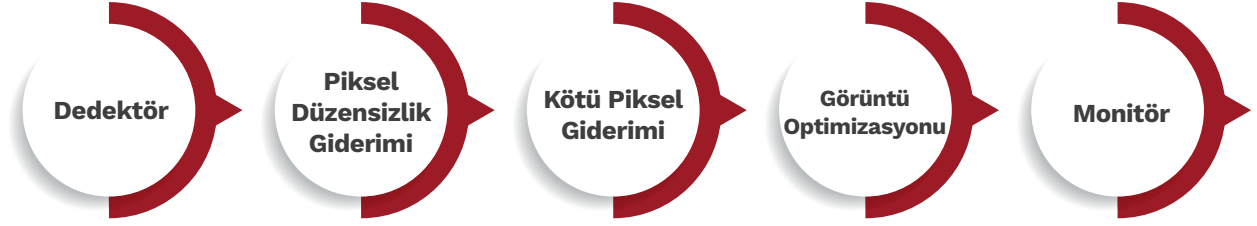
Şekil 32. Kızılötesi Verinin Görüntüye Dönüşümü İçin Gerekli İşlemler
