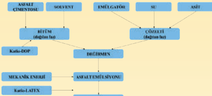
Şekil: Asfalt emülsiyonlarının hazırlanma proses
