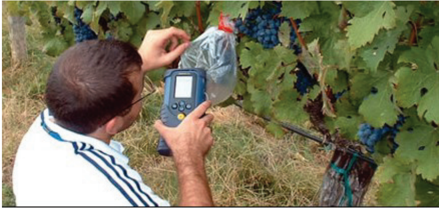
Şekil 1. Şaraplık üzümlerde elektronik burun aleti yardımı ile olgunluk durumunun tespiti
